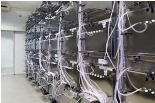
För att kunna mäta flera produkter parallellt finns i laboratoriet ca 600 kammare av olika storlekar
